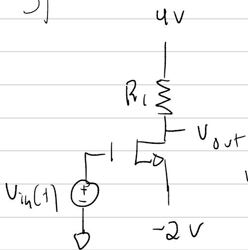
$$V_{GS} = V_G - V_S = 0 - (-2V) = 2V$$
